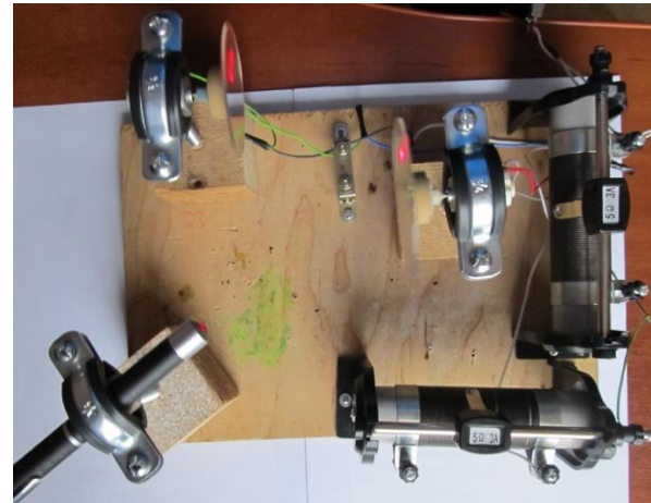
Рис. 1. Схема и фото собранного устройства: 1 – лазер с креплением и подставкой; 2 и 3 – электромоторы с зеркалами, креплениями и подставками; 4 и 5 – реостаты; 6 – демонстрационный экран
